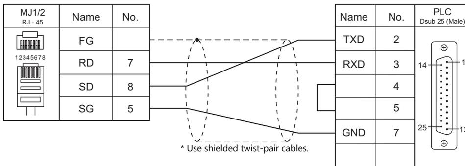
**Wiring diagram 3 - M2**
