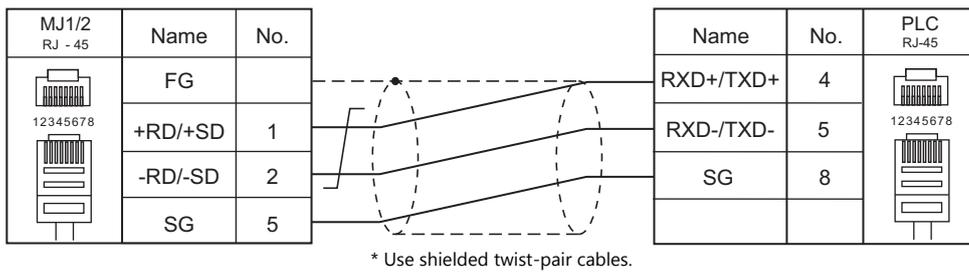
**Wiring diagram 4 - M4**
