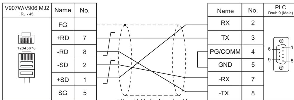
**Wiring diagram 4 - M4**
