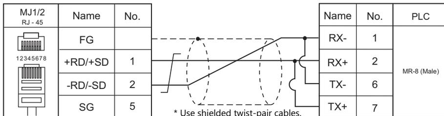
**Wiring diagram 4 - M4**
