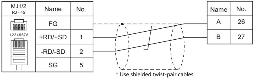
**Wiring diagram 4 - M4**
