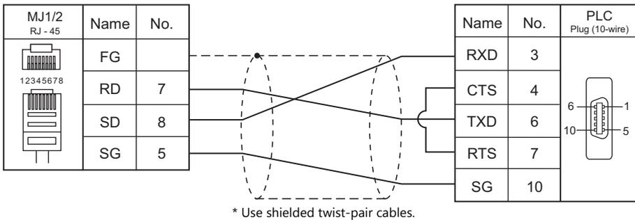
**Wiring diagram 5 - M2**
