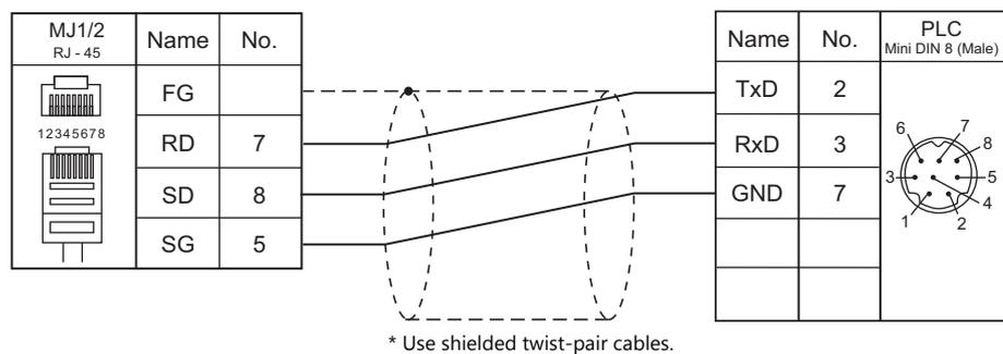
**Wiring diagram 3 - M2**
