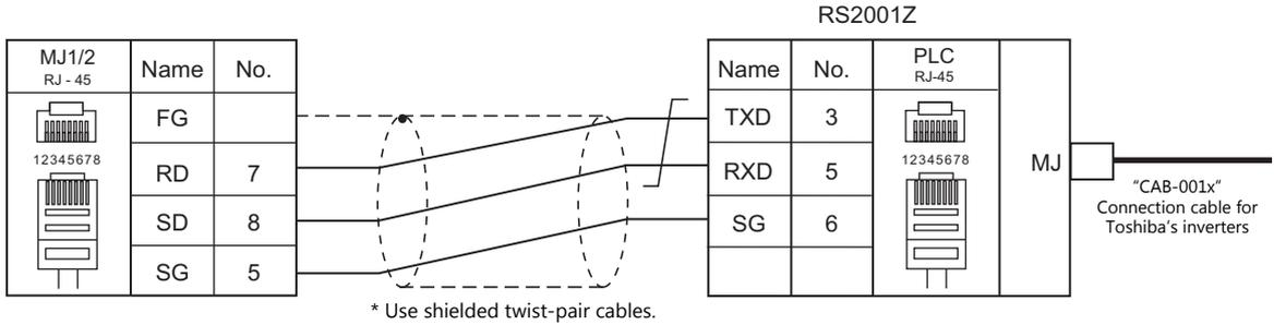
**Wiring diagram 2 - M2**
