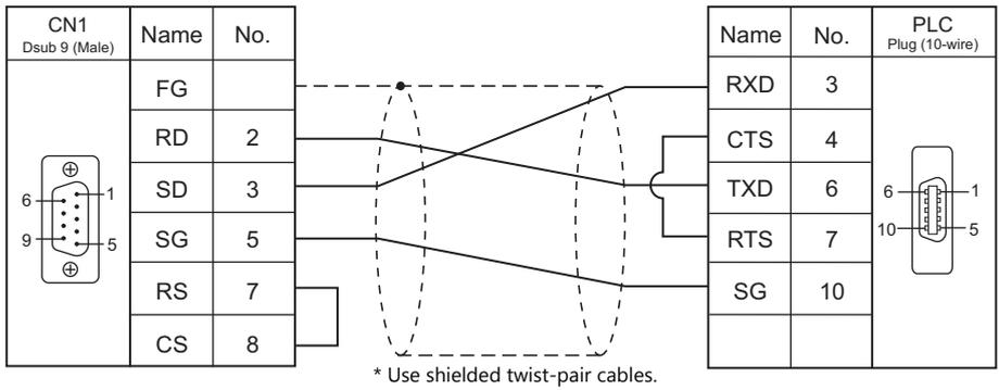
**Wiring diagram 5 - C2**
