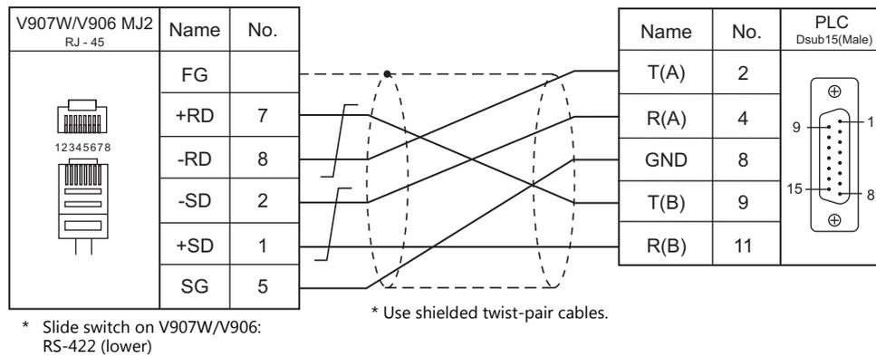
**Wiring diagram 4 - M4**
